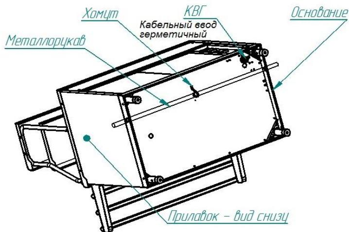
В основаниях изделий линии раздачи введено сквозное отверстие диаметром 29,5 мм и поддерживающие хомуты для возможности проведения металлического питающего кабеля сквозь все изделия линии раздачи.
